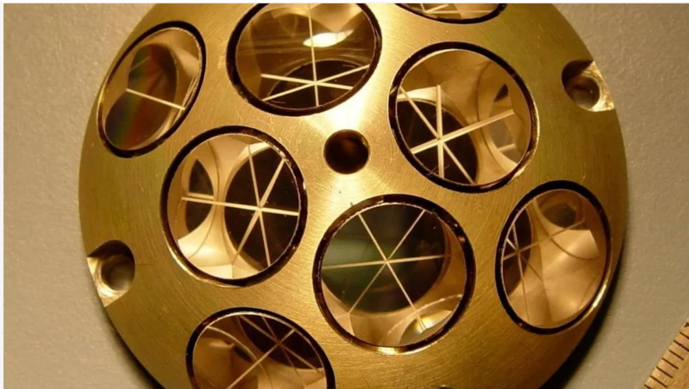
月着陸機に設置されたリトロリフレクターアレー(NASA)
