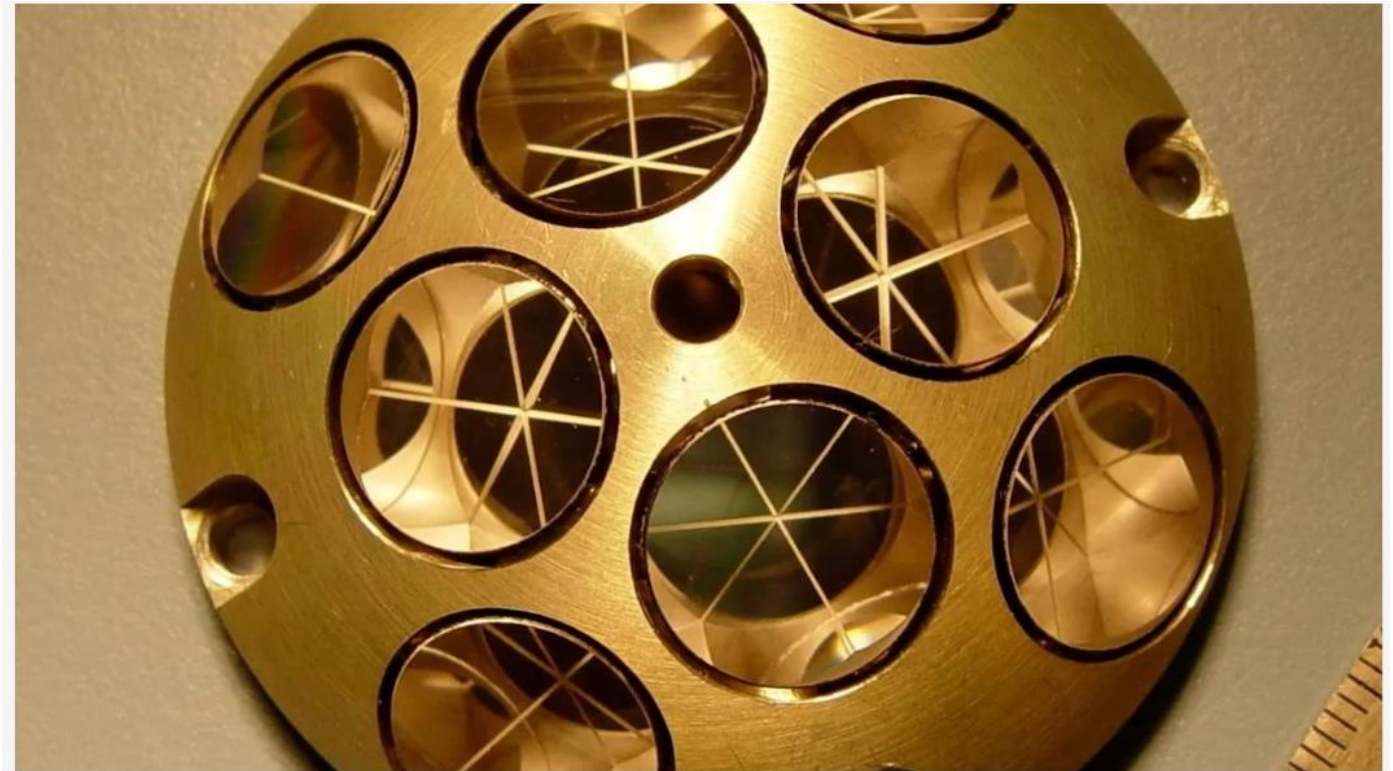
月着陸機に設置されたリトロフレクターアレー(NASA)
