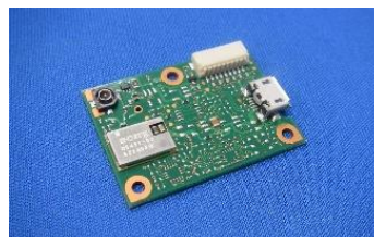
[発売中] ポジション株式会社 GSU-140評価キット 35 x 25 x 5.9mm 「GSU-141搭載」 「オプション：ジャイロ・加速度・ 地磁気・気圧」 「災危対応」
