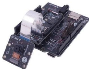
[発売中] ソニーセミコンダクタ ソリューションズ株式会社 SPRESENSE(スプレッセンズ) (CXD5602搭載) 20.6×50mm(メインボード：GNSS) 53.3×68.6mm(拡張ボード) 「カメラ機能搭載」「災危対応」
