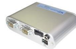
[発売中] マゼランシステムズジャパン株式会社 多周波マルチGNSS受信モジュール (ディスクリート版)評価キット MJ-3021-GM4-QZS-EVK 130×90×42 330g(本体) Φ148mm 405g(アンテナ)
