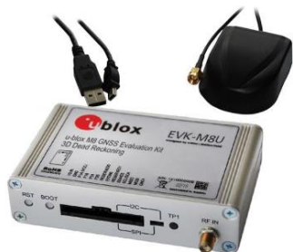
[発売中] ユーブロックスジャパン株式会社 EVK-M8U/L ( u-blox M8実装評価キット ) 105x64.0x26mm アンテナ付属、USB給電
