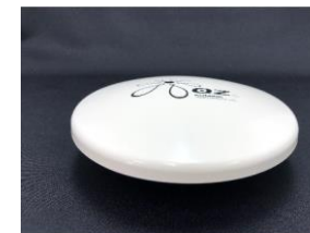
[発売中] 小峰無線電機株式会社 RJF9P2 (2周波受信チップ内蔵GNSSアンテナ) (u-blox ZED-F9P内蔵) 周波数：1590±30MHz, 1238±40MHz 140(直径)×50mm、250g USB接続 「L1C/A, L1S/L2対応」
