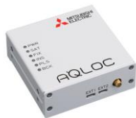
[発売中] 三菱電機株式会社 AQLOC-Light 受信機：90×90×30mm, 280g アンテナ：59×59×33mm, 150g IMU内蔵
