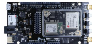
[発売中] ユーブロックスジャパン株式会社 C099-F9P ( u-blox ZED-F9P評価キット ) 17.0x22.0x2.4mm アンテナ付属、USB給電 Bluetooth / Wi-Fi antenna 実装 「L1C/A,L1S/L2対応」
