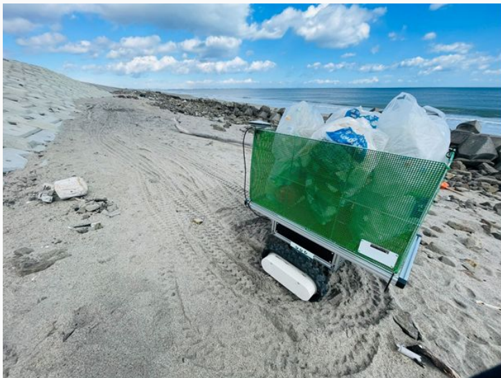
宮城県岩沼市砂浜海岸における自動走行実験 (左:実験の様子, 右:3回自動走行の軌跡)
