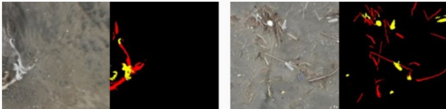
セグメンテーションAIによる検出例 (左：空撮画像，右：人工物を黄色，自然物を赤で出力)
